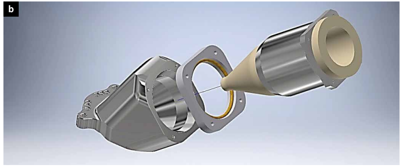
Bild 1: a) Dosiereinheit der Meltec Industrieofenbau GmbH, angepasst an den vakuumdosierten Druckgießprozess, b) Detailansicht – (von links) Einfüllstutzen aus Stahl, Deckplatte mit integrierter Dichtung, Keramiktiegel mit Stahlhülse.
