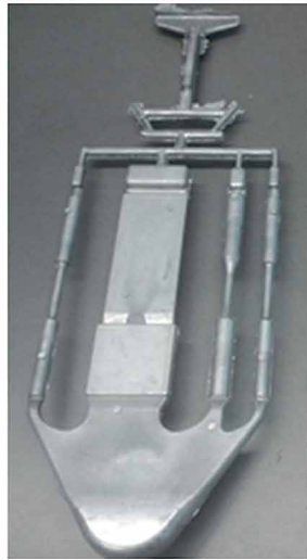
Bild 4: Versuchsgussteil und Diagramm zur Darstellung der Streuung der statischen Festigkeitswerte konventionell/vacural.
