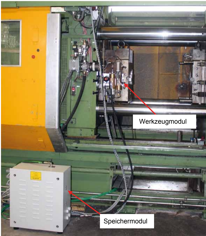
Bild 3: Realer Aufbau des neuen Gasinjektionssystems mit Verdichtermodul, Speichermodul und Werkzeugmodul an einer Kaltkammerdruckgießmaschine..
