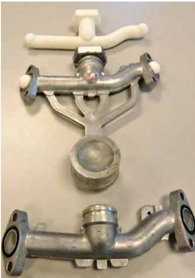
Bild 6: Wasserauslassstutzen aus Aluminium-Druckguss, hergestellt unter Verwendung eines Salzkerns [24].
