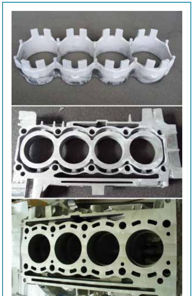
Figure 14: Wassermantelkern und Zylinderkurbelgehäuse von Mercedes, Werk Untertürkheim [16].
