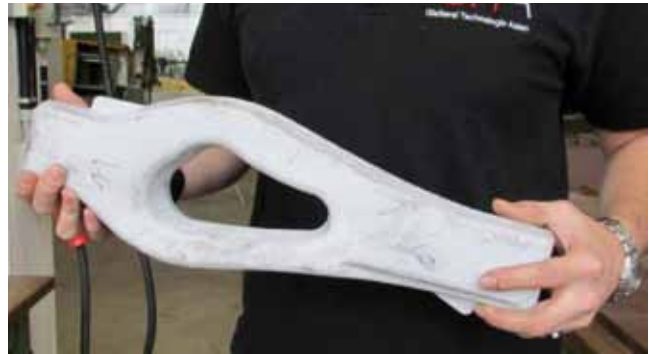
Bild 13: Hohler Demonstrator-Großkern für mögliches Strukturbauteil [11, 12].
