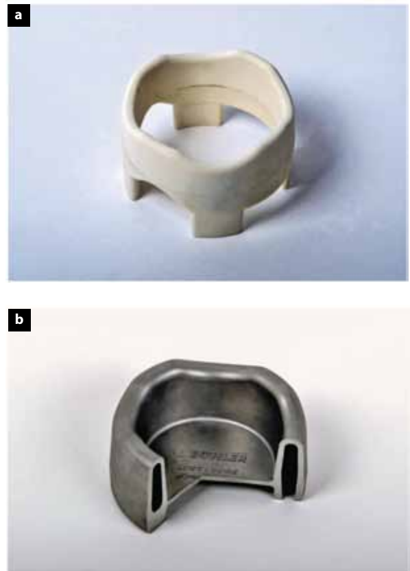
Bild 7: a) Salzkern und b) Demonstratorbauteil der Bühler AG [13].
