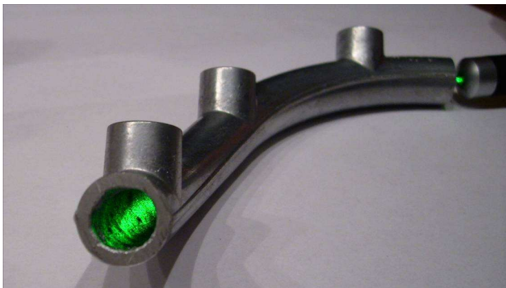
Abbildung 1: 3-dimensionaler Hohlkanal eines Druckgussteils
