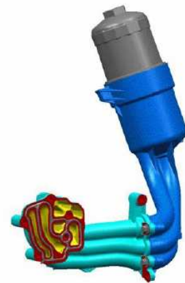
Abbildung 2: Ausblasen von Ölkanälen bei druckgegossenen Ölfiltergehäusen
