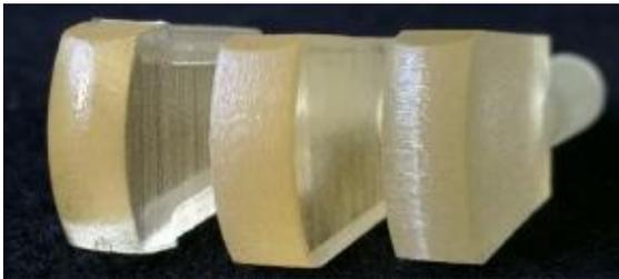
Abb. 3: Teilmodule in verschiedenen Ausrichtungen gedruckt.
